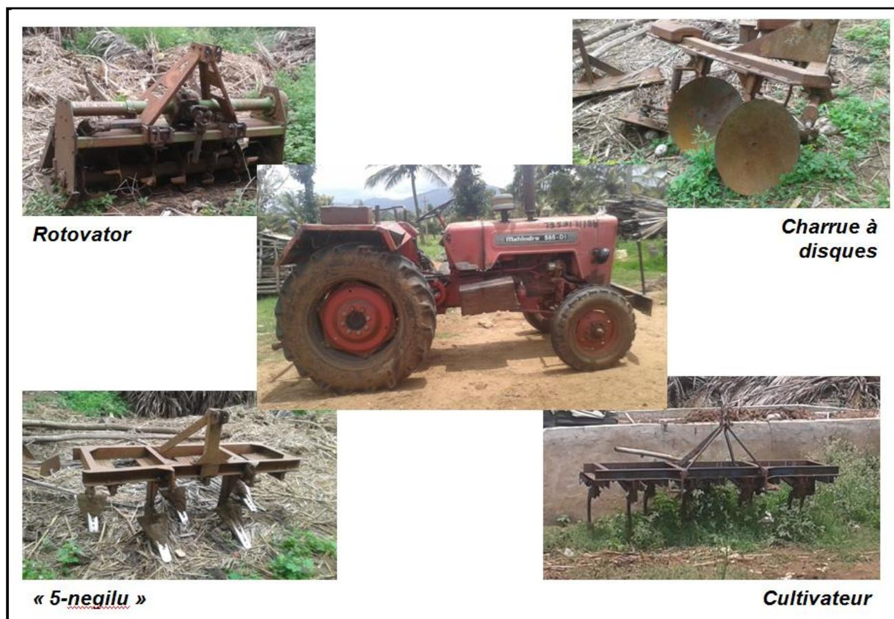
Figure 40: Tracteur et équipements tractés
